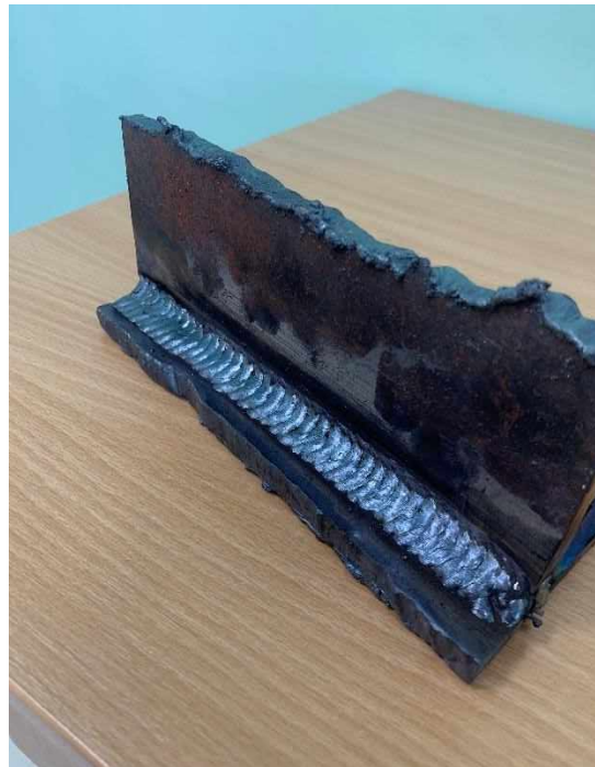
Рис. 6. Сварка порошковой проволокой
